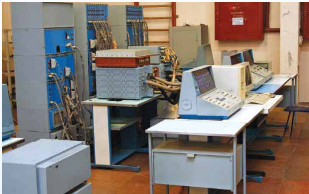
Технологическая, наземная и бортовая аппаратура для отработки программ ЦВК
