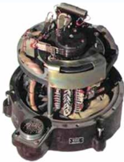
Гироскопический интегратор разработки НИИ-944, применявшийся на первых советских ракетах
