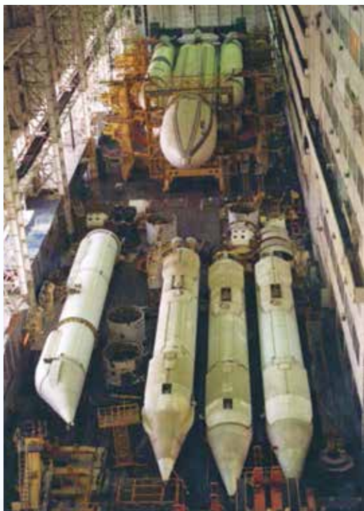
Первая ступень РН «Энергия» состояла из четырех боковых блоков разработки КБ «Южное» и изготовления ЮМЗ
