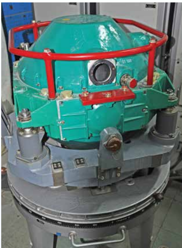
Гироскопическая сферическая платформа СУ ракеты Р-36М2
