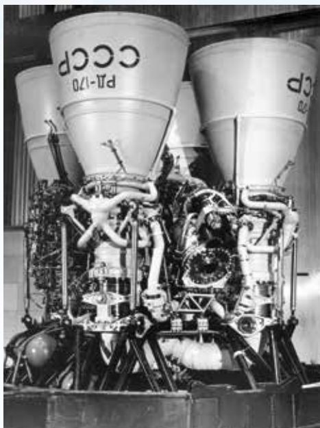
4-камерный кислородно-керосиновый двигатель РД-170 бокового блока РН «Энергия»
