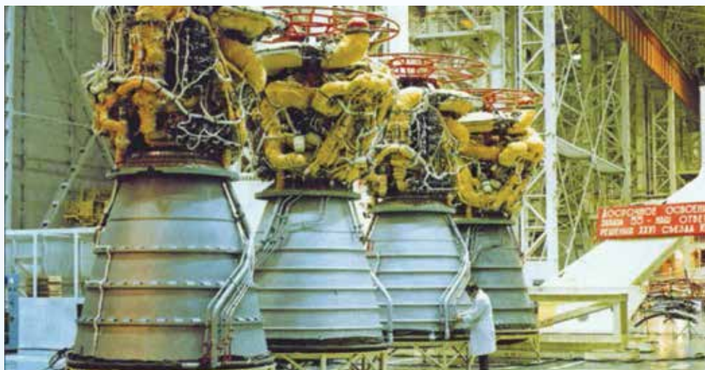
Центральный блок второй ступени РН «Энергия» оснащался четырьмя кислородно-водородными двигателями РД-0120
